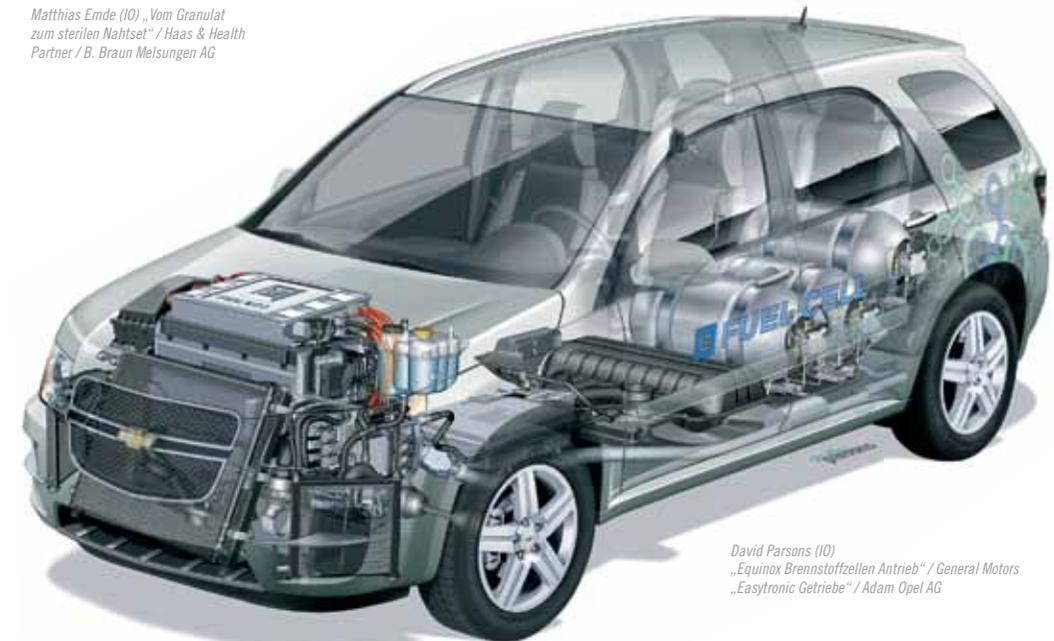
David Parsons (IO) „Equinox Brennstoffzellen Antrieb“ / General Motors „Easytronic Getriebe“ / Adam Opel AG
